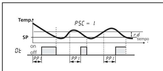
El segundo control prevé la inhibición de la salida "OT" por un intervalo mínimo configurado en el parámetro "PPP", después que la salida fue apagada (retraso después de apagar o tiempo mínimo de compresor encendido).
