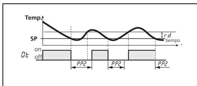
El tercer control determina el tiempo mínimo entre accionar la salida "DTT", configurado en el parámetro "PP2" (retraso entre partidas).
